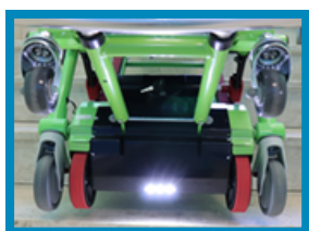
Eclairage des marches par LED
